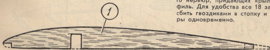
НЕРВЮРА КРЫЛА В НАТУРАЛЬНУЮ ВЕЛИЧИНУ - ФАНЕРА 1 мм
