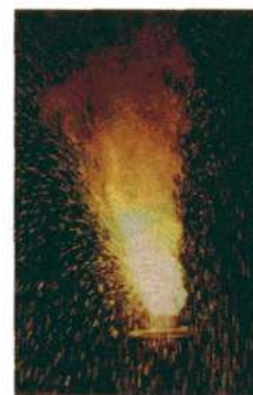
Алюминий. Алюминотермия: восстановление железа из оксида алюминием.
