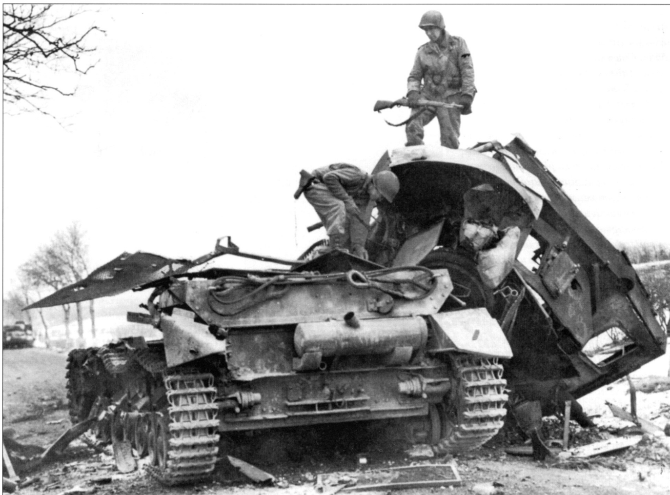
Два американских солдата осматривают подбитый танк Pz.Kpfw. IV Ausf. J из 6-й роты 1-го танкового полка СС, подбитый самоходкой M10 из 644-го батальона истребителей танков под Вирицфельдом 17 декабря. Танк построен в сентябре – октябре 1944 г. уже после того как поступило распоряжение прекратить нанесение циммерита. Танк оснащен новыми проволочными бортовыми экранами. Необычен цилиндрический глушитель старого типа. Танки поздней постройки (с августа 1944 г.) оснащались вертикальными выхлопными патрубками с пламегасителями. В борту баини видна сквозная пробоина от снаряда. Вдали стоит еще один подбитый танк Pz.Kpfw. IV.
