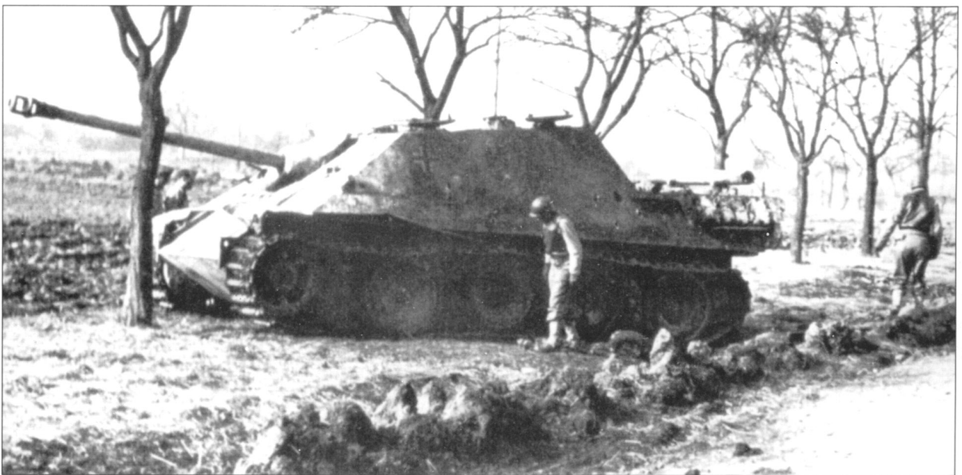
«Ягдпантера» из 654-го тяжелого батальона истребителей танков на шоссе у Веккершира. Снимок сделан после того, как Кольмарский выступ был очищен от немцев американскими войсками. Ствол орудия находится в положении крайнего отката – машина выведена из строя экипажем. Скорее всего, самоходка поломалась или горючее кончилось. В бортовой броне рубки видны отметины от прямых попаданий снарядов. Различив крест на борту рубки и остатки цифр бортового номера «131».
