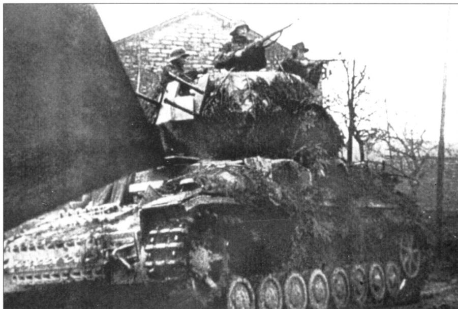
В кампфгруппе Пейпера в ходе штурма Стомона имелось, как минимум, два зенитных танка Flakpanzer IV Wirbelwind. На снимке – экипаж зенитного танка готов ответить на обстрел американцев винтовочным огнем. Эта машина перестроена из танка Pz.Kpfw. IV Ausf. G.
