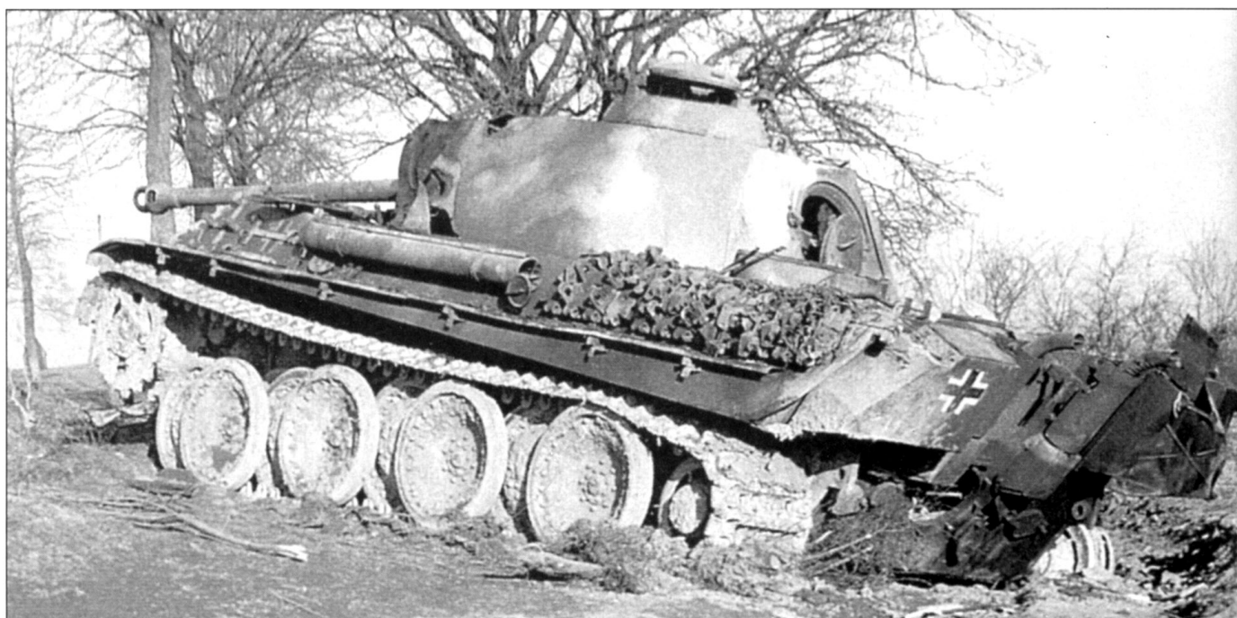
Танк «Пантера» Ausf. G из Учебной танковой дивизии, подбитый под Бюссонвиллем вскоре после Рождества. В передней части борта башни видны две сквозные пробоины от снарядов. На крыше моторного отделения виден увеличенный кожух вентилятора, работавшего на обогрев боевого отделения.
