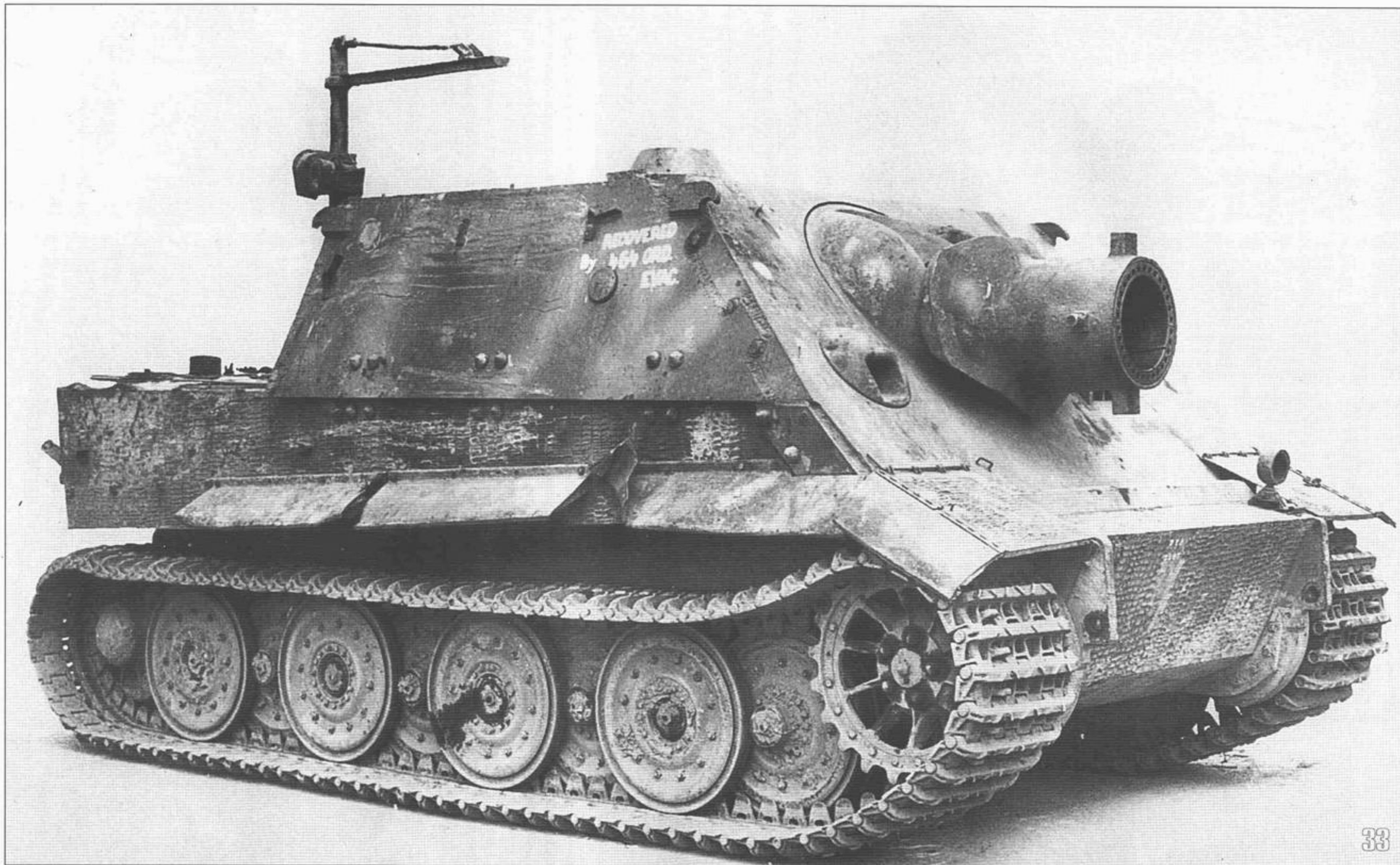
33. Этот «Штурмтигр» был захвачен английскими войсками и проходил испытания в Великобритании. На корпусе танка имеется циммеритное покрытие, противовес на стволе бомбомета отсутствует.
