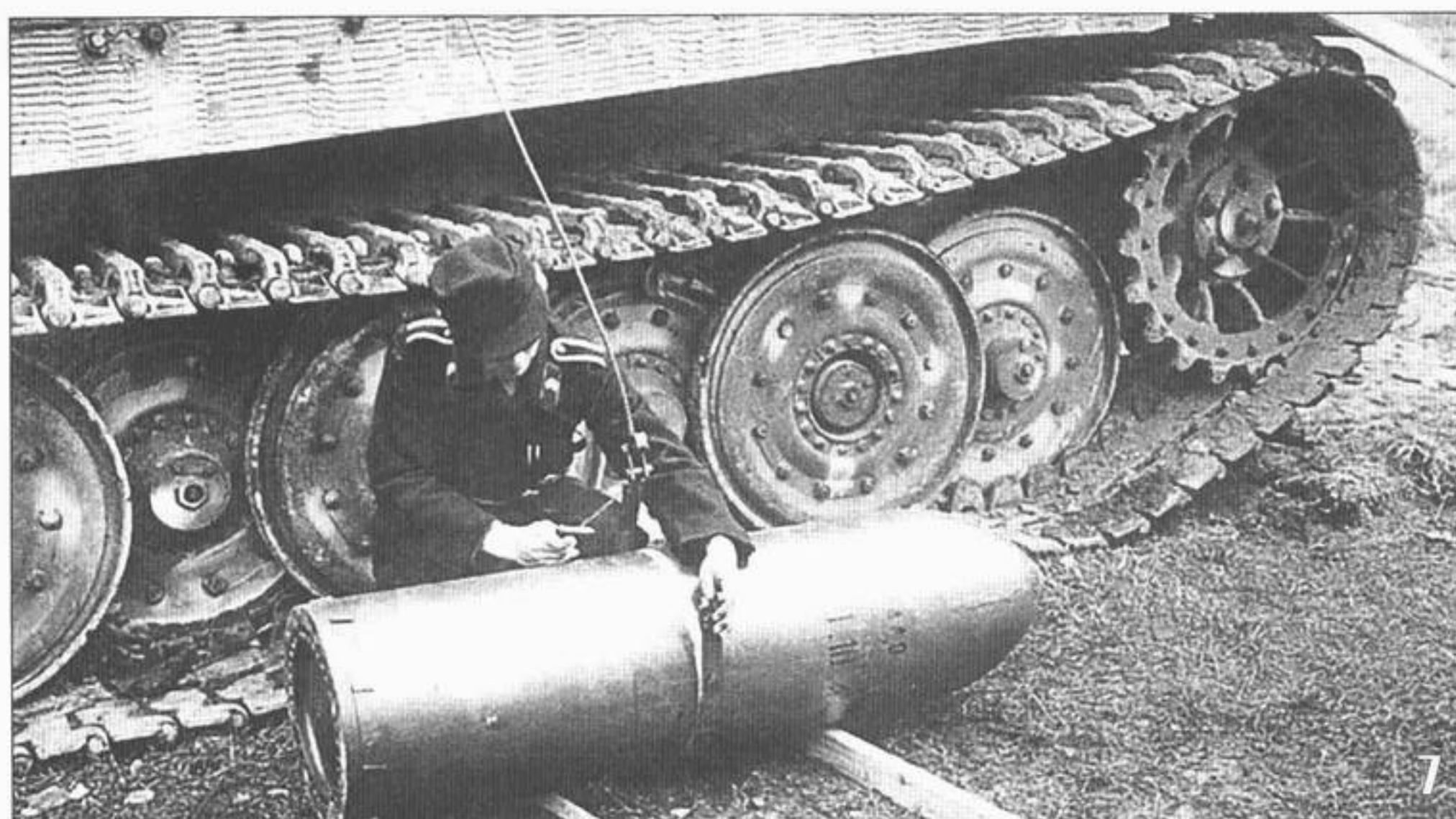
7. Зацепление 380-мм ракеты краном для загрузки в «Штурмтигр».
