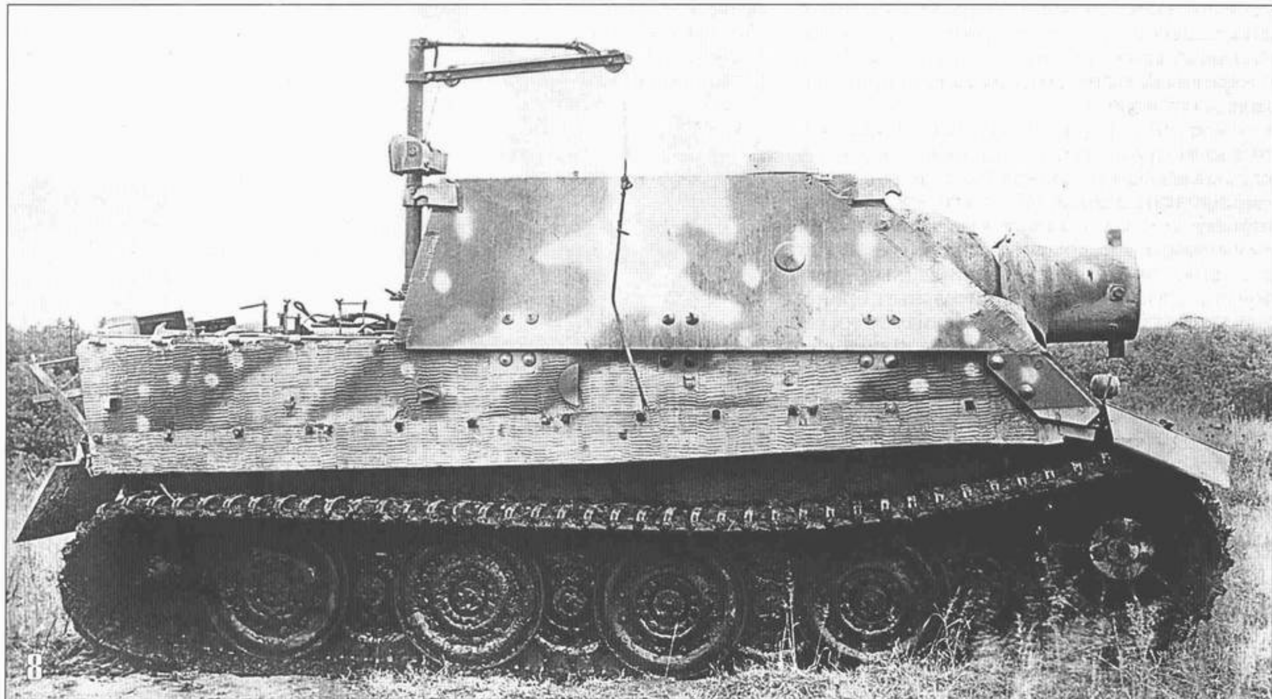
8, 9. Серийный «Штурмтигр» во время испытаний на одном из полигонов Германии, предположительно сентябрь 1944 года. Машина не имеет бортовых крыльев и противовеса на стволе бомбомета.
