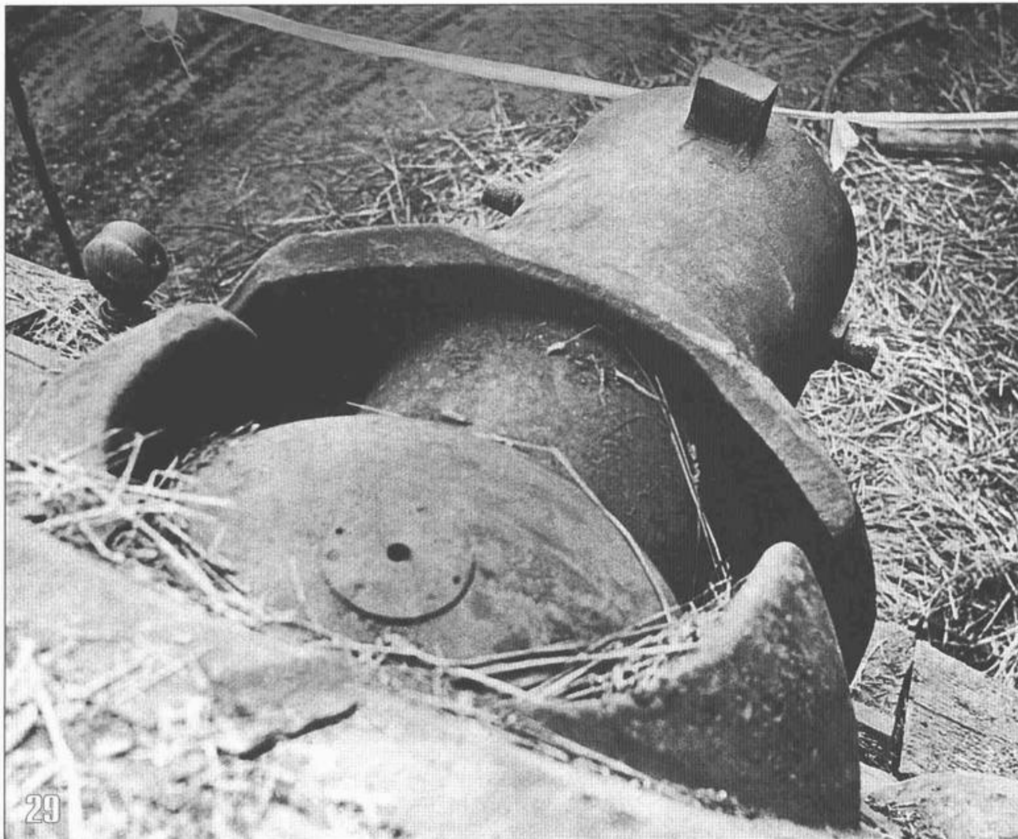
29, 30. Вид на шаровую установку 380-мм бомбомета «Штурмтигра», изображенного на фото 23–28. Противовес на стволе отсутствует.
