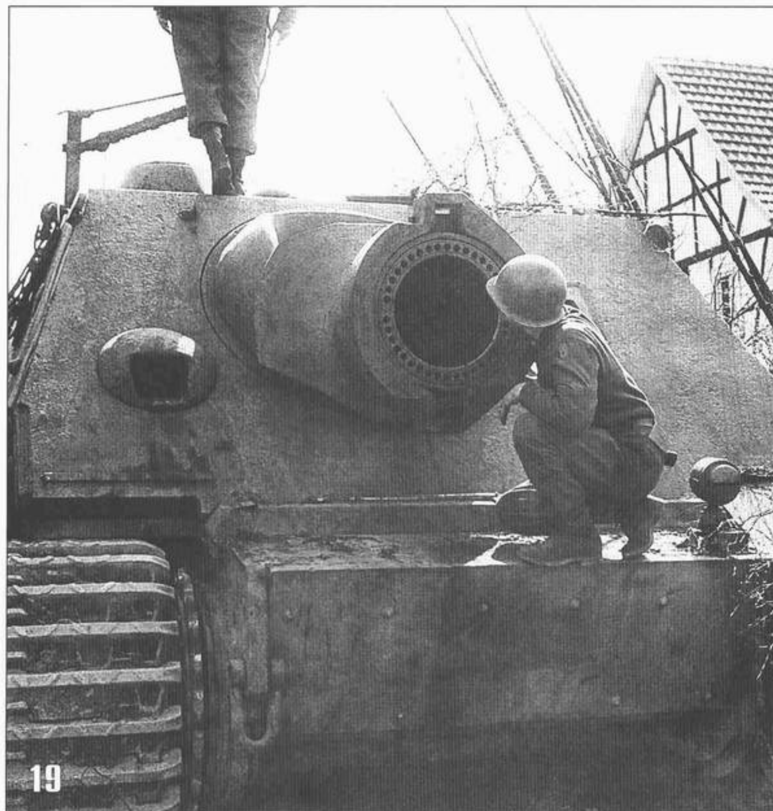
19. Американцы осматривают еще один трофейный «Штурмтигр». Германия, весна 1945 года. Этот танк имеет дополнительную бронеплиту на переднем листе корпуса, противовес на стволе бомбомета (по конструкции схожий с установленным на машине, находящейся в Кубинке, смотри фото 42, 43). Количество отверстий для выхода пороховых газов в верхней и нижней половине ствола одинаково — по 20.
