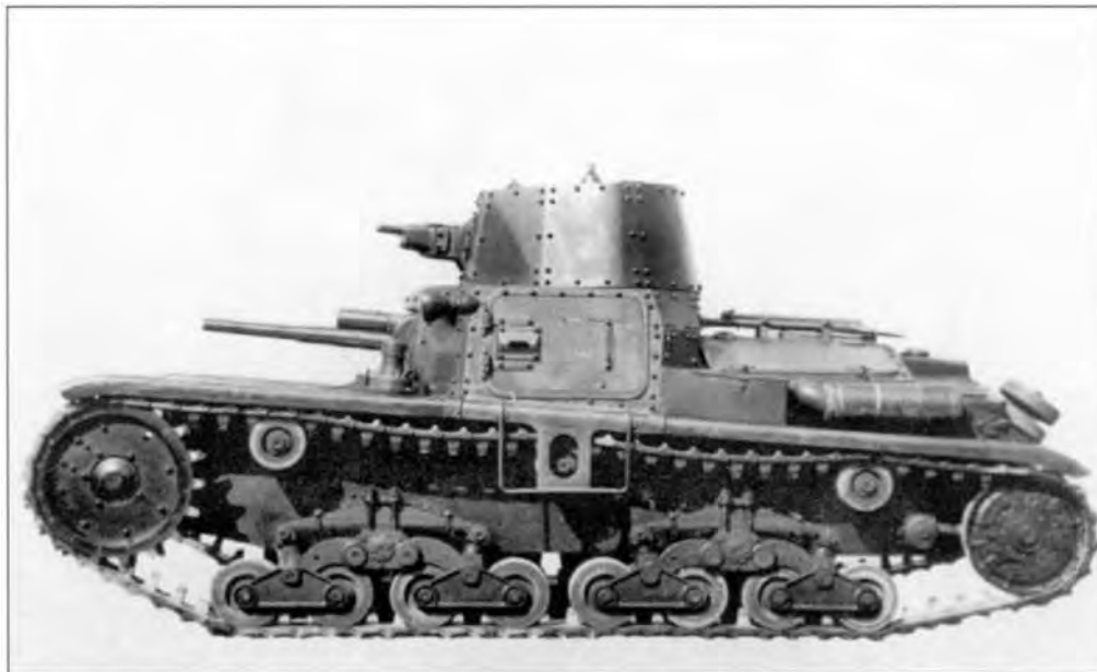
Серийный танк М11/39. Серийные машины отличались от прототипа отсутствием радиостанции и несколько модифицированными крыльями
