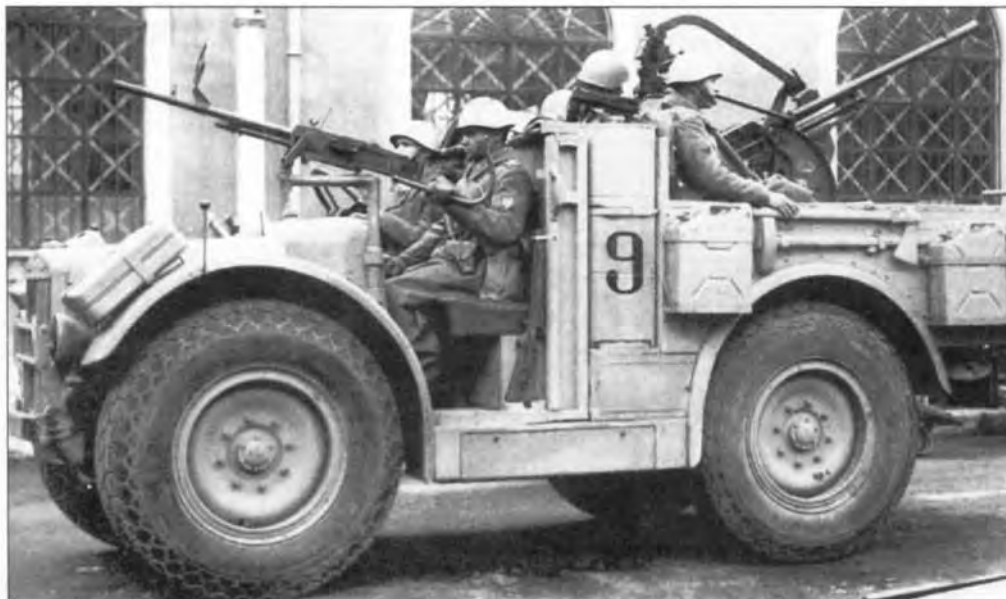
Этот AS 37 модернизирован Экспериментальным центром моторизации в Риме для штурмового батальона «А»
