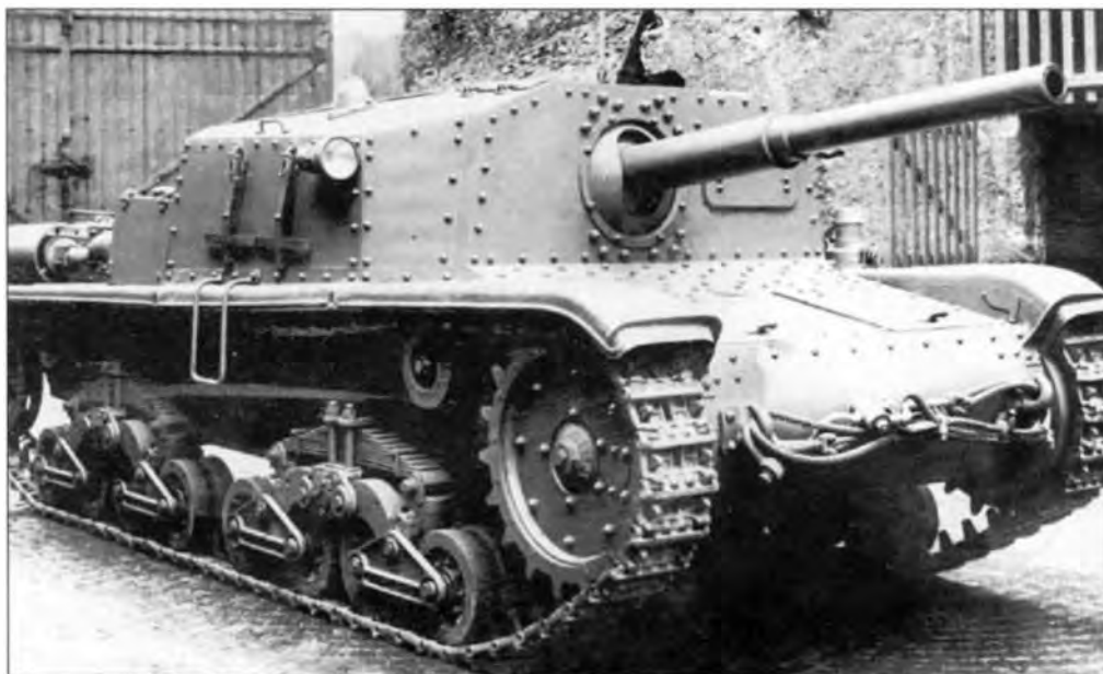
Самоходная установка Semovente da 75/34 на шасси танка M15/42. 1943 год
