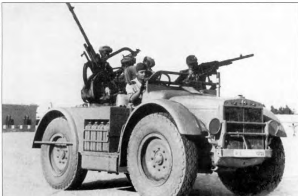
Усилиями армейских мастерских в Северной Африке многие тягачи AS 37 были превращены в боевые машины с мощным вооружением. На этой машине установлены крупнокалиберный пулемет и 20-мм автоматическая пушка
