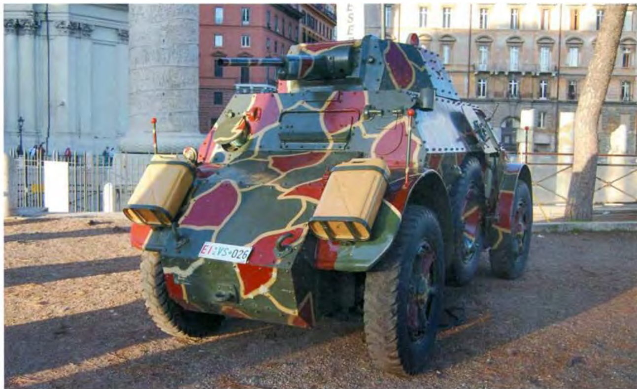
Бронеавтомобиль АВ 41 поздних выпусков с башней, заимствованной у АВ 43 и установленной в ней 20-мм пушкой, во время военного шоу в Риме. 2010 год
