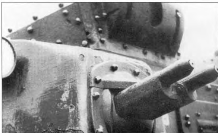
Спаренная установка пулеметов Breda 38. Стволы пулеметов были защищены литым броневым кожухом
