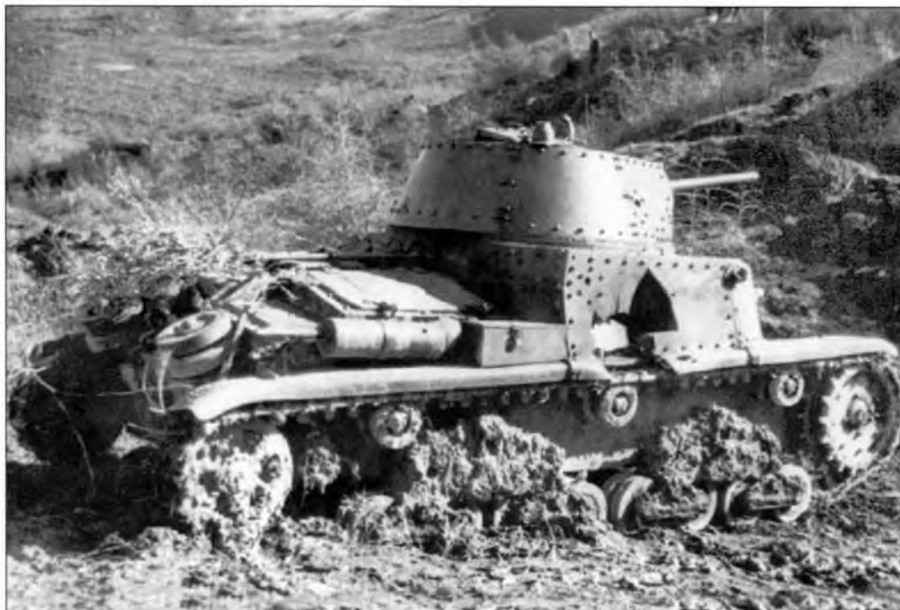
Танк М13/40 подбитый огнем греческой артиллерии во время боев в Албании в январе 1941 г. В борту машины хорошо видна пробоина от снаряда
