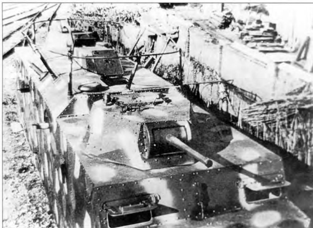
Вид сверху на бронедрезину LIBLI. Хорошо видна конструкция орудийных башен
