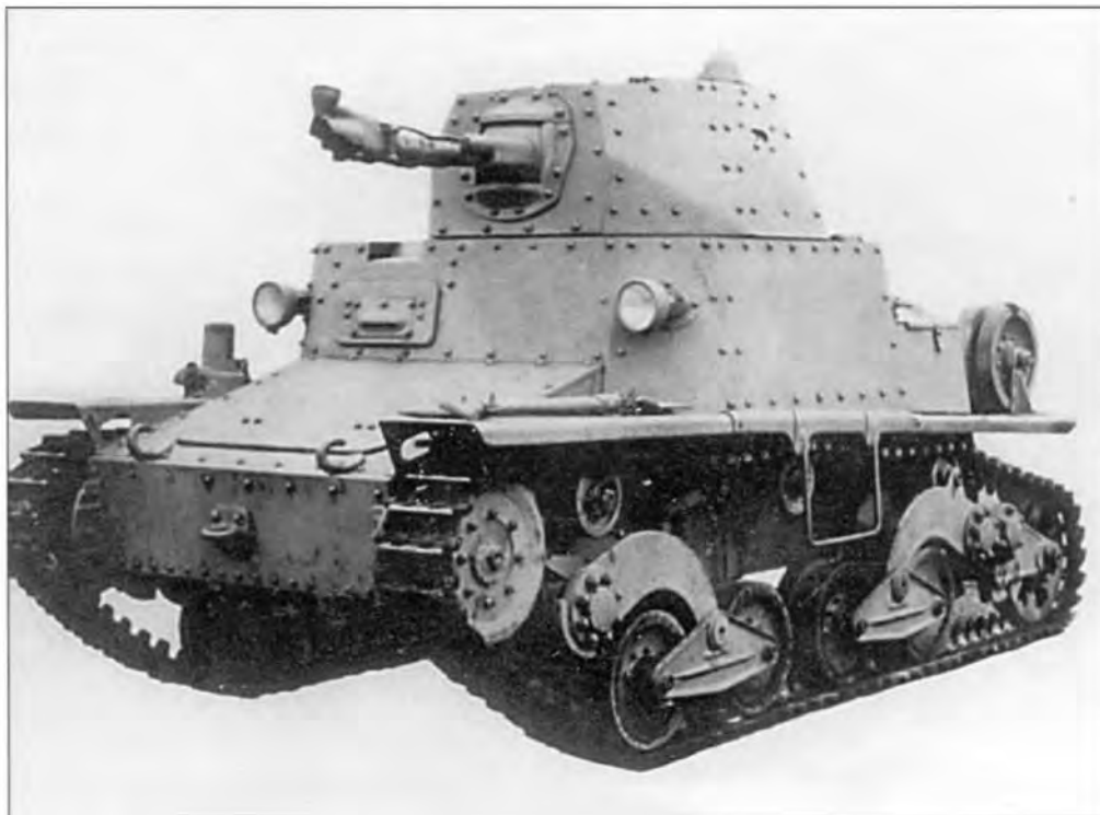
Огнемётный танк L6/40 L.F. Огнемёт установлен в башне вместо 20-мм пушки
