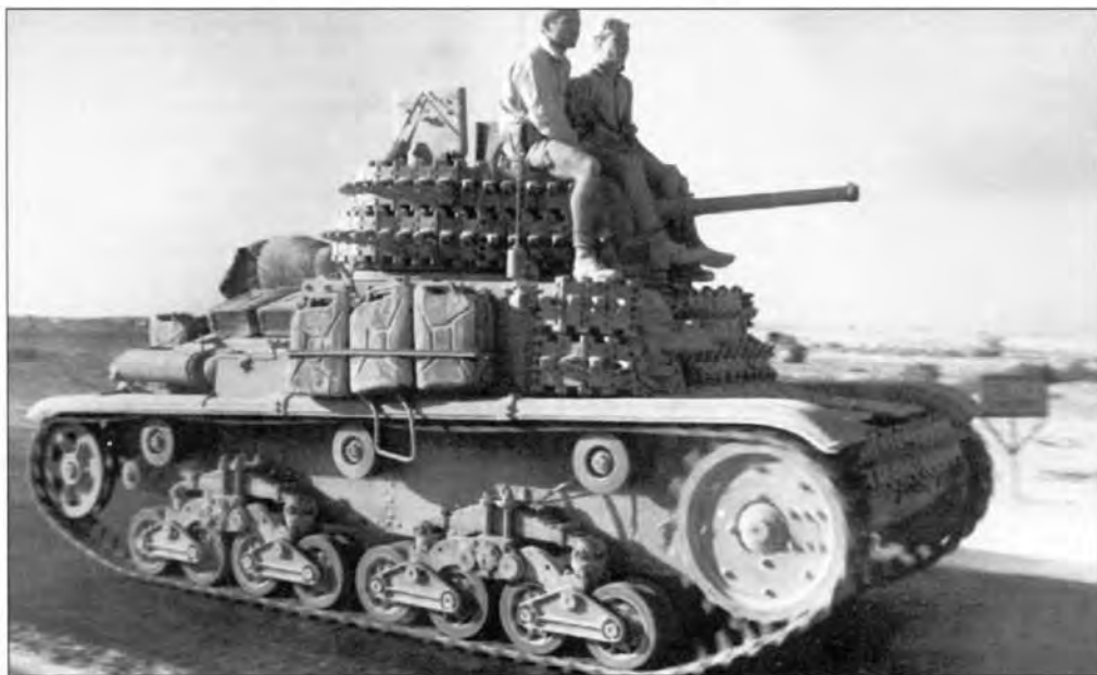
Танк М14/41 из состава танковой дивизии Centauro движется к линии фронта. Северная Африка, 1942 год. В качестве дополнительной защиты на этой машине используются гусеничные траки
