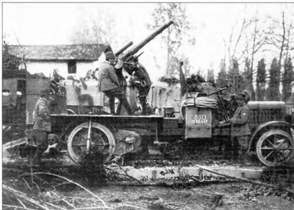
75-мм пушка Krupp 75/L27 на грузовом автомобиле Itala X на боевой позиции
