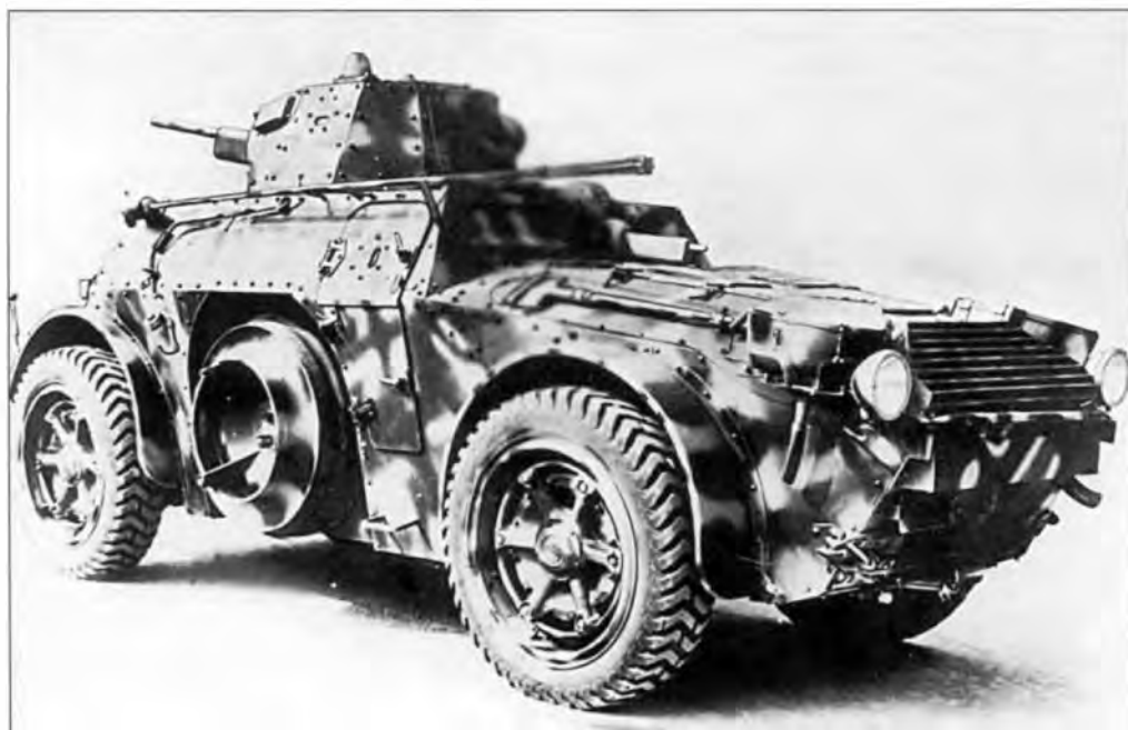
Бронеавтомобиль-дрезина AB 41 Ferrovie. Железнодорожные скаты размещены в нишах по бортам корпуса
