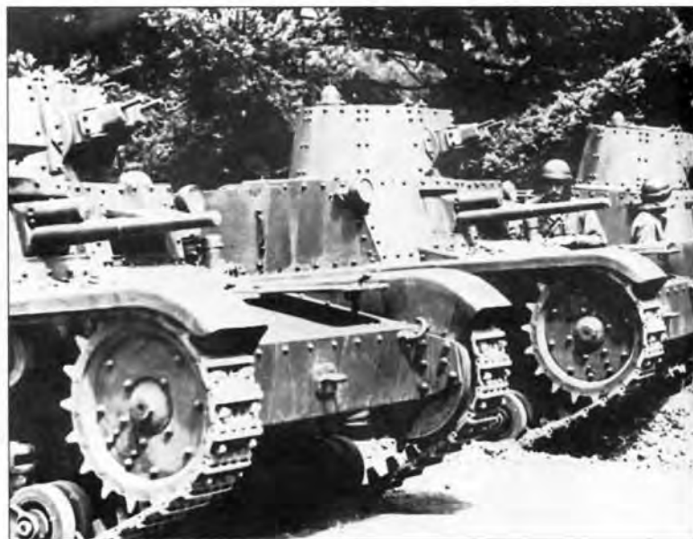
Танки М11/39 в строю. Хорошо видно вооружение боевых машин: 37-мм пушка в корпусе и два пулемета Breda в башне
