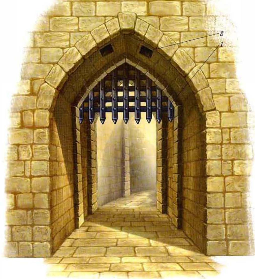
Ворота в замок 1 — решетка; 2 — засадные отверстия
