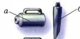
1 — зарядная камера орудия XIV–XV вв. из Эстонии (Археологический музей, Таллинн); 2 — бомбарда конца XIV в.; 3 — зарядная камера малого казнозарядного орудия XV–XVI вв. из Сирии или Египта (музей Цитадели в Алеппо, Сирия); 4 — легкое орудие XV в. со сменной зарядной камерой (а) и клиновым запирающим ствол (б);
