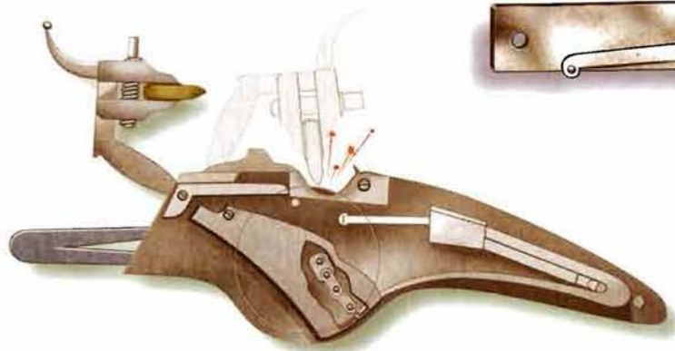
Колесцовый замок в разрезе
