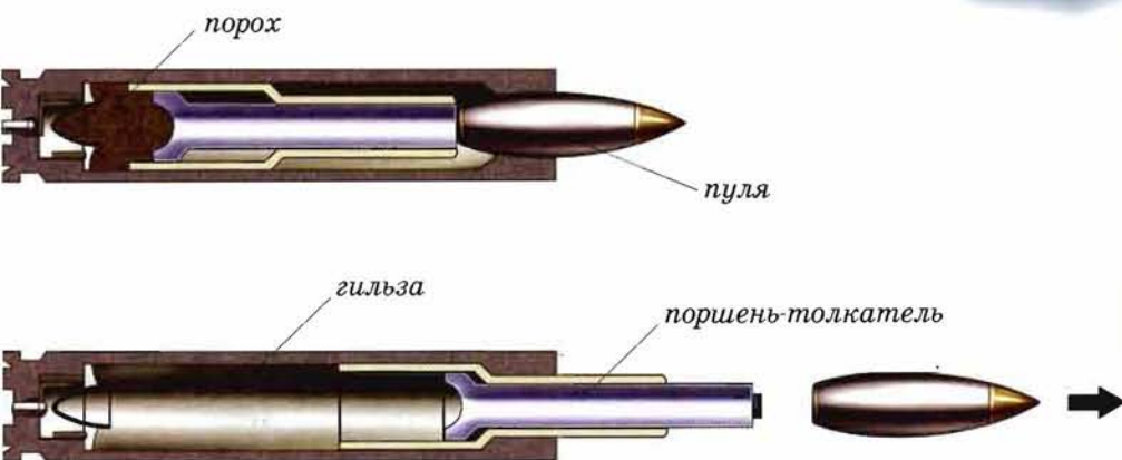
Как был устроен и как работал патрон для бесшумной стрельбы
