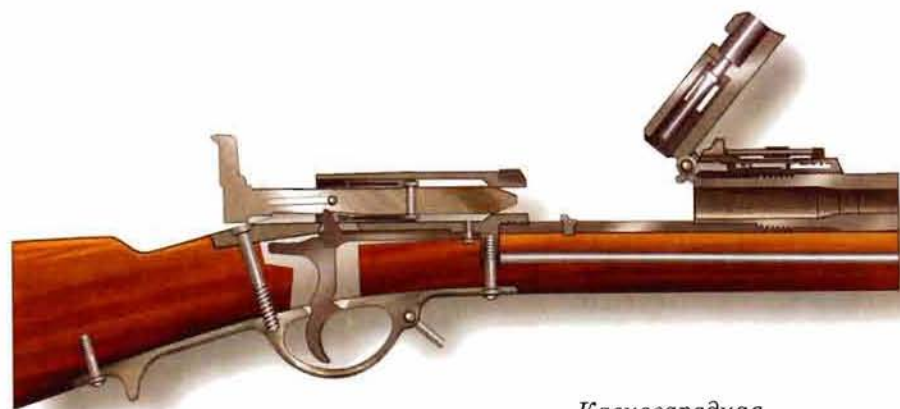
Казнозарядная винтовка Бердана №1 с откидывающимся затвором
