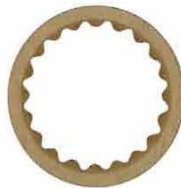
Нарезы в стволе значительно повысили точность стрельбы
