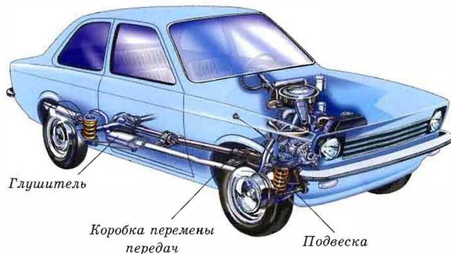
шестерни разных размеров, позволяет, переключая вращение с одних шестерен на другие, изменять скорость движения автомобиля. Низкая передача (большие шестерни) — низкая скорость, но при этом высокая мощность, необходимая для разгона или трогания с места. Высокая передача (малые шестерни) — высокая скорость, но низкая мощность. Впрочем, для движения с высокой скоростью большая мощность и не нужна.
