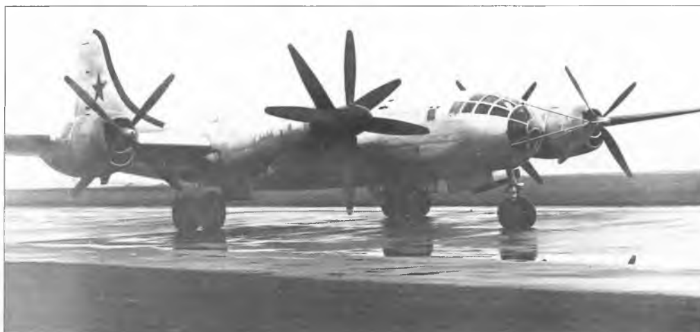
Бомбардировщик Ту-4 использовался в качестве «летающей лаборатории» для испытаний двигателей ТВ-2
