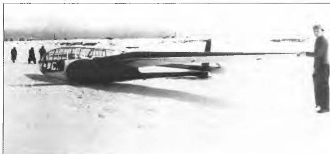
Модифицированный планер «Краних» использовали для приобретения опыта пилотирования в лежачем положении
