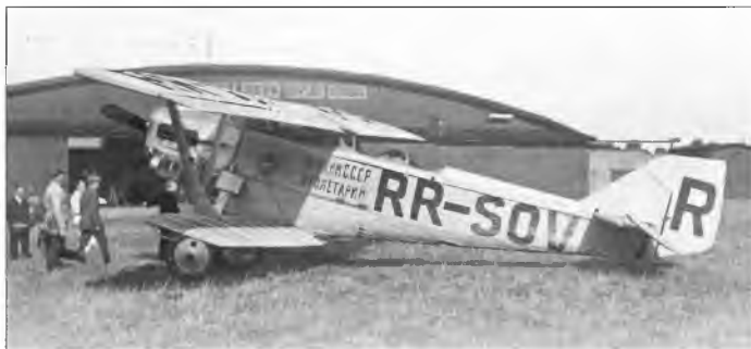
АНТ-3 (P-3) — первый серийный металлический самолет А.Н.Туполева. В 1926 г. на этой машине был совершен демонстрационный перелет по городам Европы
