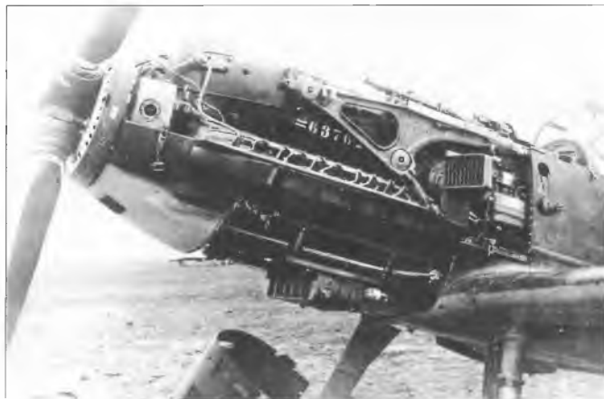
Раскапченный мотор трофейного Ff 109E. Хорошо видны агрегаты винтамоторной группы
