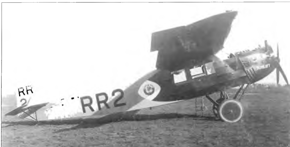
С 1925 г. на линии появились усовершенствованные «Фоккеры» с измененным капотом двигателя, увеличенным килем и закрытой кабиной экипажа
