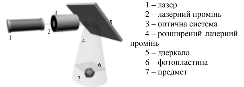
Рис. 1. Тривимірна модель діючої установки для голографування
