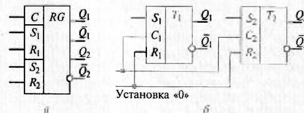
Рис. 3.18. Условное графическое изображение (а) и функциональная схема (б) двухразрядного регистра
