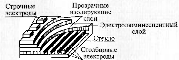
Рис. 5.27. Конструкция электролюминесцентной панели
