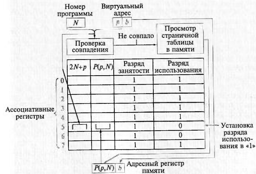
Рис. 3.39. Функционирование АЗУ PMT при отсутствии в нем информации о странице и отсутствии свободного регистра
