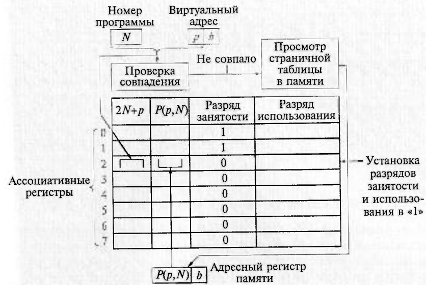
Рис. 3.38. Функционирование АЗУ PMT при отсутствии в нем информации о странице и наличии свободного регистра
