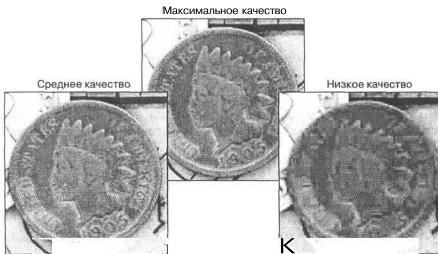
Рис. 3.1. Если вы сохраните файл изображения в формате JPEG с высокой степенью сжатия, качество изображения может существенно ухудшиться
