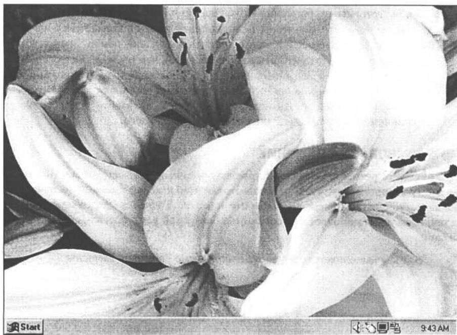
Рис. 9.2. Цифровой фотоснимок размером 640x480 пикселей занимает всю площадь экрана, также имеющего разрешение 640x480 пикселей
