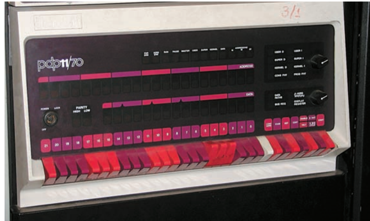
Компьютер PDP 11/70 использовал восьмеричную кодировку.
