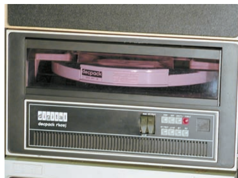
Дисковод сменного магнитного диска PDP-11 объёмом 2,5 Мбайт.
