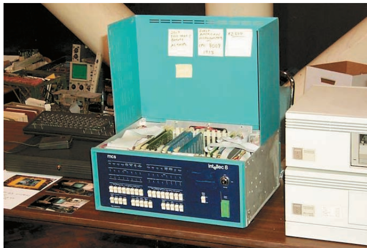
Одна из первых микроЭВМ, Intellec 8 (базирующаяся на процессоре Intel 8008), стоила около 2,5 тыс. долларов.
